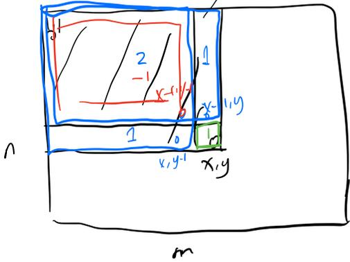
$$b_{x,y} = b_{x,y-1} + b_{x-1,y} - b_{x-1,y-1} + a_{x,y}$$
